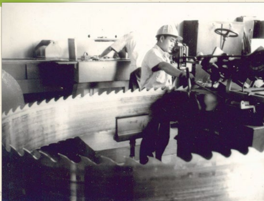
李鐘雄提出「大剖機鋸片齒角與製材率之關係」研究論文，獲得輔導會頭等獎，也更建立了他對相關研究的信心。圖為磨鋸間大剖機鋸片研磨作業。
