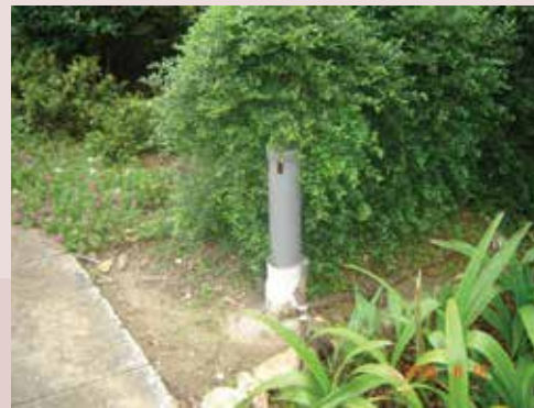
魚池周圍加裝紅外線警示器。
