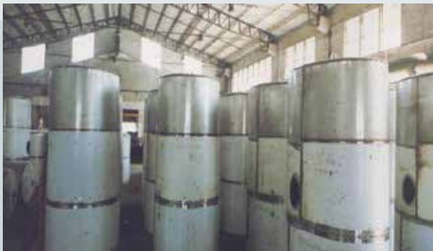
不銹鋼油灌車之筒身焊接。
