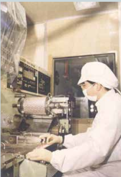
藥品真空成型包裝機作業。
