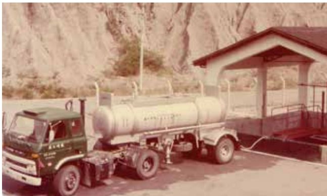
硝甘炸藥原料混酸槽車及儲酸池。
