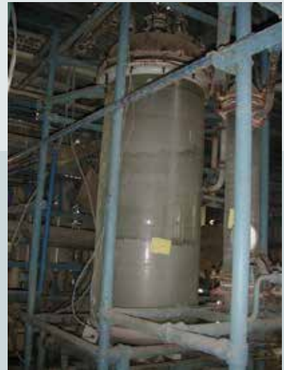
酸場生產線濃硫酸槽。
