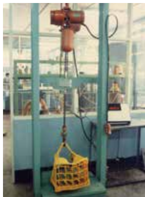
啤酒箱品管破壞拉力測試。
