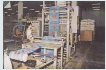
自動化製袋設備作業情形。
