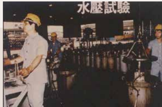
鋼瓶之水壓試驗。
