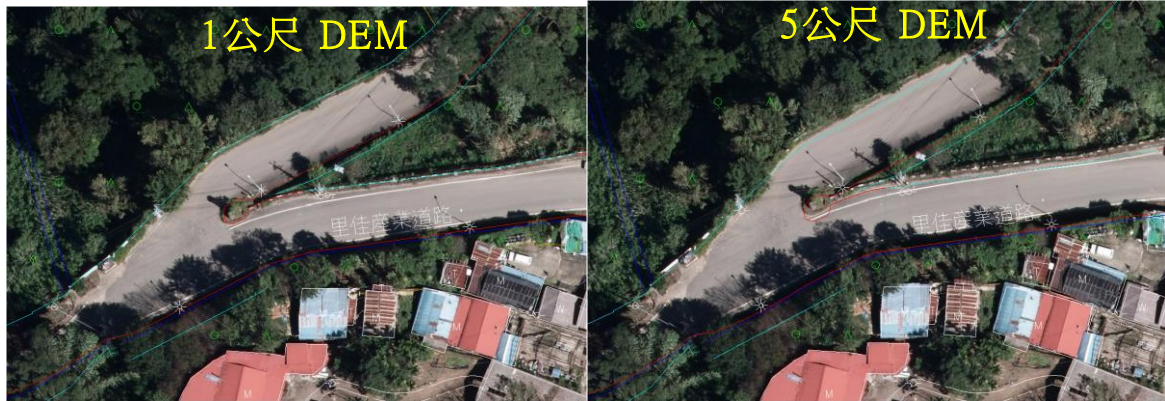
圖3-4 不同網格 DEM 正射影像糾正示意圖
