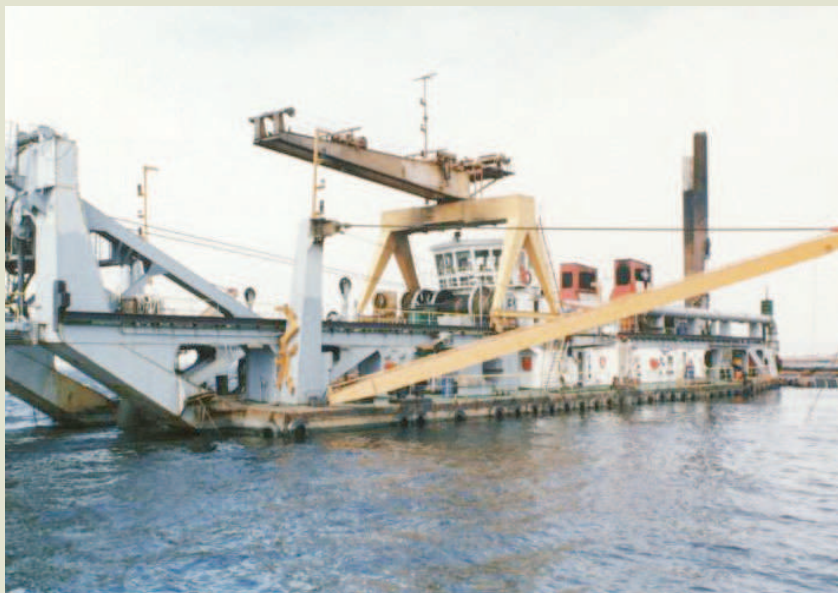
海事工程隊之主力船之一 - 10,000匹馬力的大興號挖泥船。
