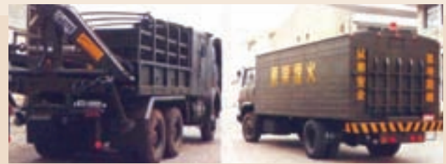
台北鐵工廠為軍方打造之拖砲車及硝化甘油運輸車車身。
