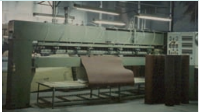
楠梓工廠砂紙布生產設備
