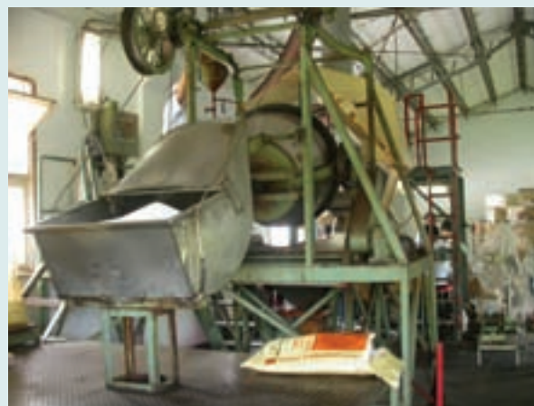
硝油炸藥生產設備
