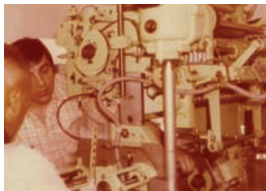
德國技師指導硝甘炸藥包裝機校正作業
