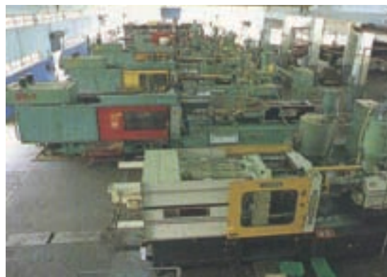
生產啤酒箱等產品之機具設備
