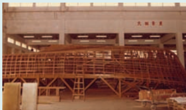
製作遊艇船體模具之骨架
