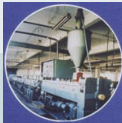
生產PE管之機器
