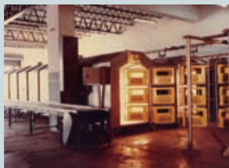
生產啤酒箱表處作業
