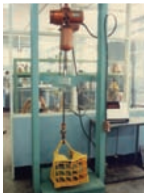
啤酒箱品管破壞拉力測試
