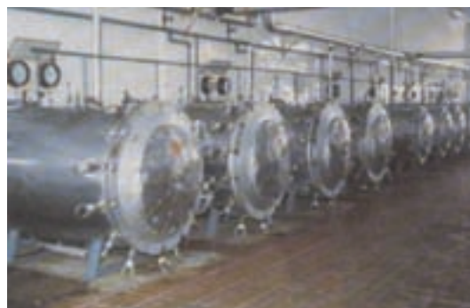
罐頭高溫殺菌設備
