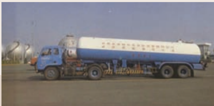
液化石油氣供應處之運送設備
