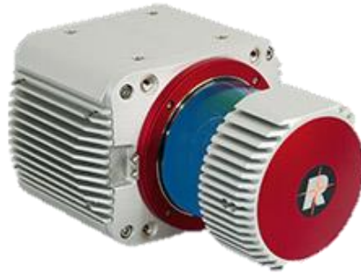
圖3-45 RIEGL VUX-1LR 空載光達
