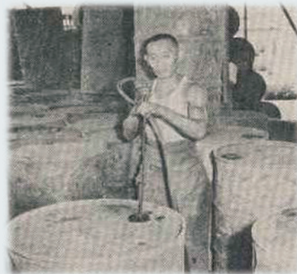
油桶內噴注防銹油作業（民國51年）。
