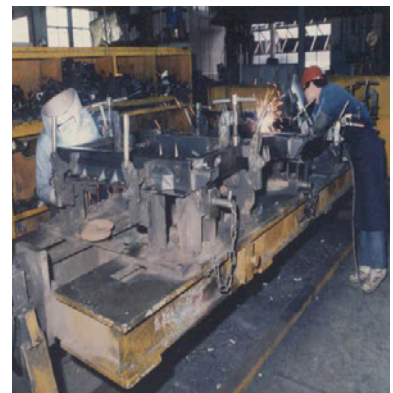
汽車大樑焊接作業。
