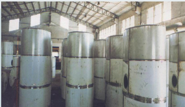
不銹鋼油灌車之筒身焊接。
