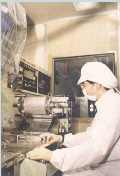
藥品真空成型包裝機作業。
