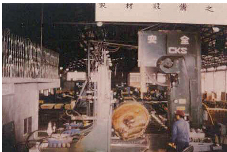
原木剖材機製材作業。
