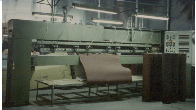
楠梓工廠砂紙布生產設備。
