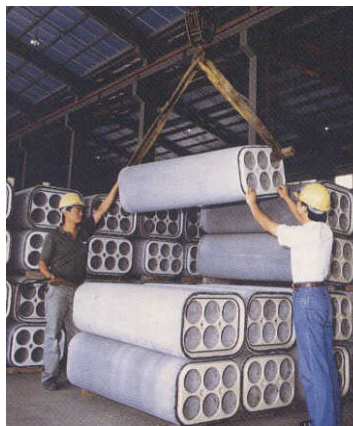
與民間合作生產之電纜導管。
