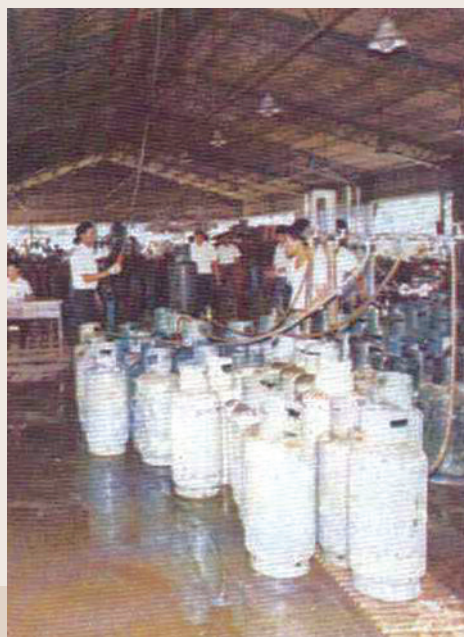
液化石油氣驗瓶作業。
