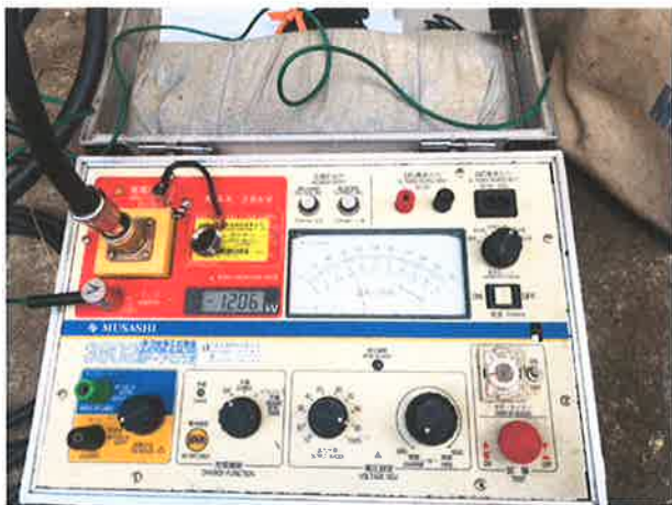
說明：高壓絕緣電阻測試，記錄照片。
