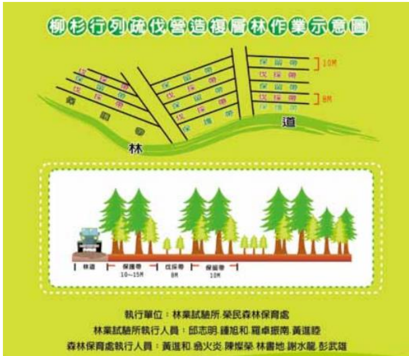
圖3-11 魚骨式柳杉人工林行列疏伐作業示意圖
