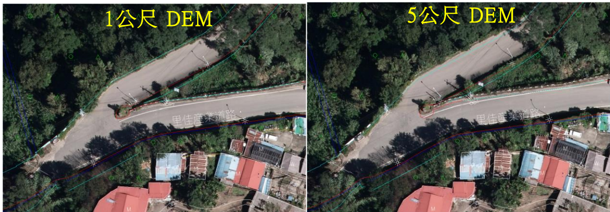
圖2-7 不同網格 DEM 正射影像糾正示意圖
