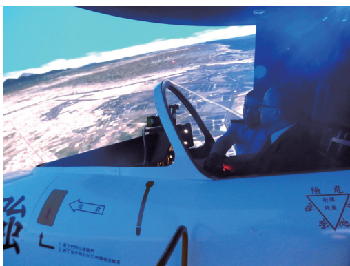
AT-3 模擬機帶飛情況，圖左上為天地線，可供參考平飛之用。（圖／空軍官校）
